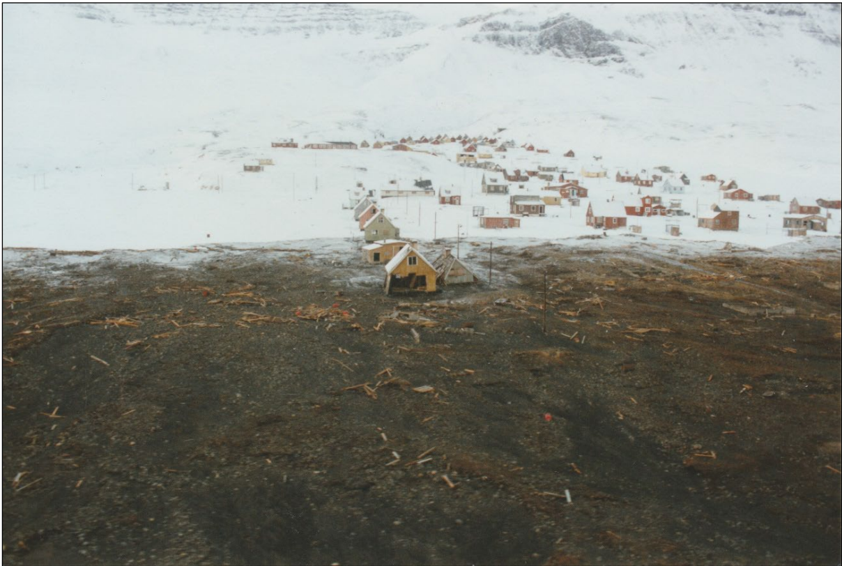
Figur 5: Foto fra Qullissat taget dagen efter tsunamien i 2000. Kystlinjen er lige udenfor bunden af billedet. På grund af sneen i billedet ses det tydeligt, hvilken del af bygden som blev overskyldet af tsunamien. Opskyldet nåede maksimalt 12 m højde. De nederste huse blev totalt ødelagte, mens det grønne hus, som står netop på opskylslinjen, kun har mindre skader. Foto fra Politiet i Ilulissat.
